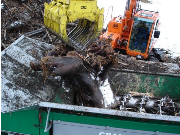
Grobholzstücke werden mit einem Zweiwellen-Zerreisser zerkleinert
