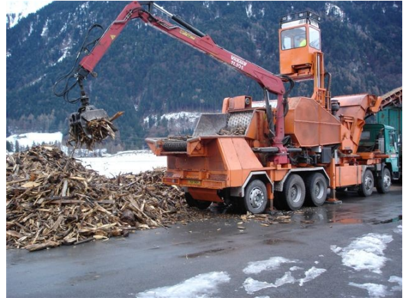
Zerkleinertes Holz wird mit Grosshacker zu Schnitzeln gehackt
