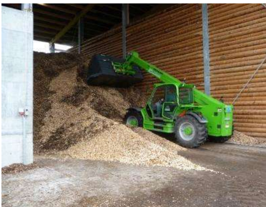
Silobefüllung mit Teleskopklader
